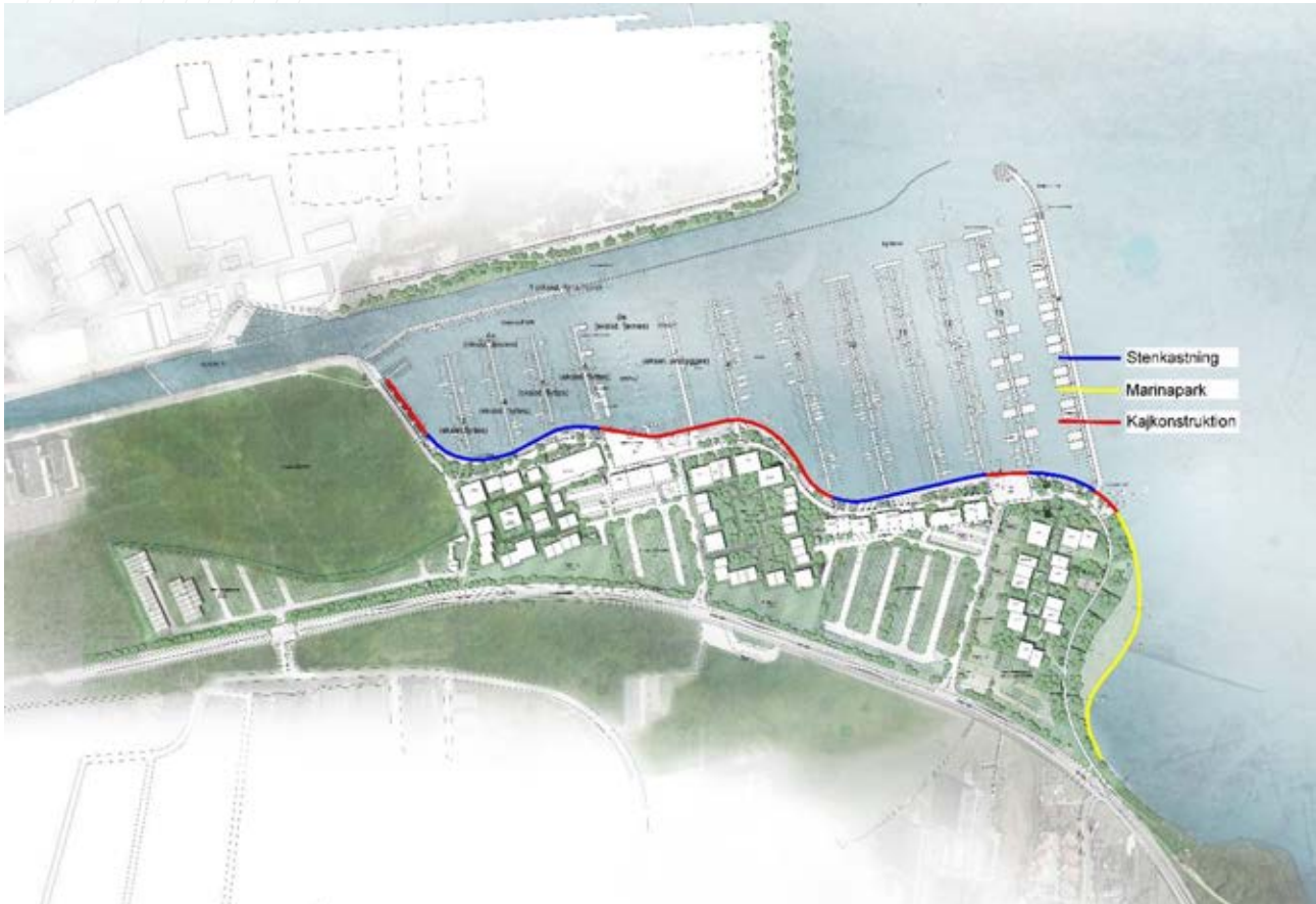
Figur 3-6: Optimeret havnelayout med angivelse af beliggenhed af anlægselementer. Detaljerede kortudsnit i høj opløsning kan ses i bilag 14.
