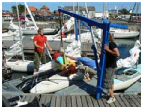
Figur 3-22: Eksempel på personløfter.
